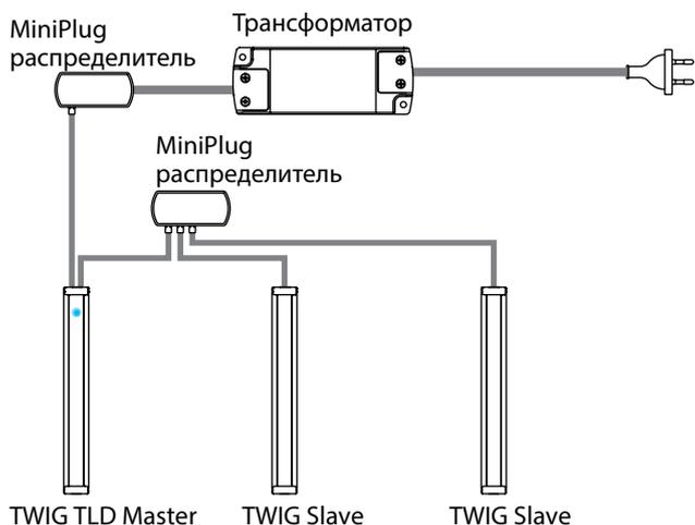
**Схема подключения комбинации Twig IFR Master и Twig Slave**
