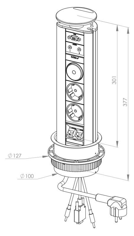
Einbaubohrung Ø 102 mm
