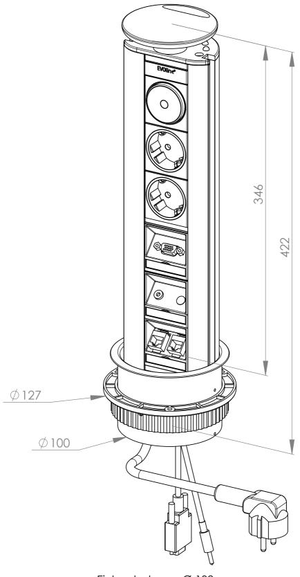
Einbaubohrung Ø 102 mm
