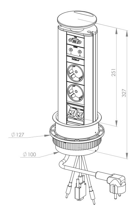
Einbaubohrung Ø 102 mm
