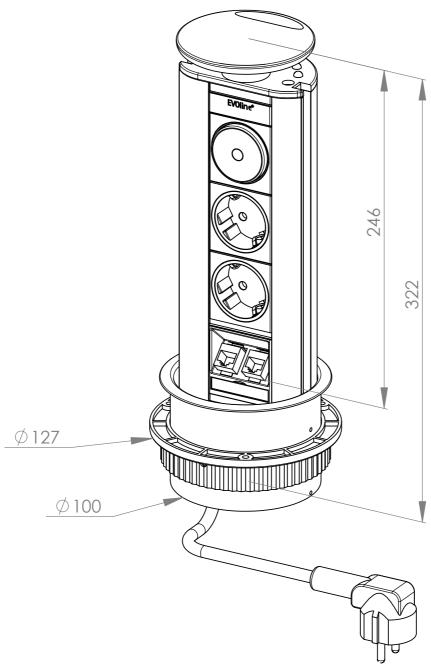
Einbaubohrung Ø 102 mm
