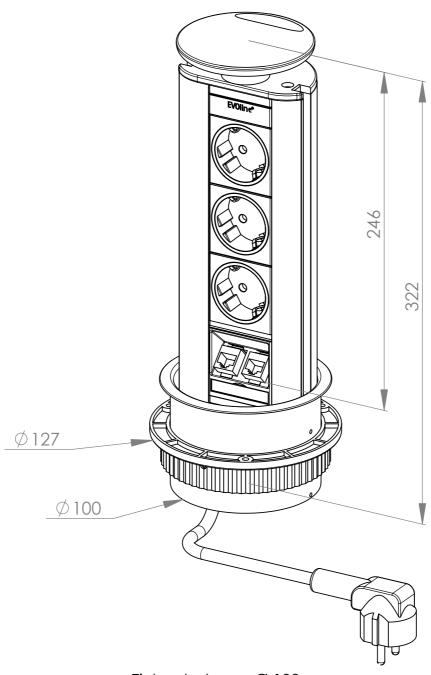
Einbaubohrung Ø 102 mm
