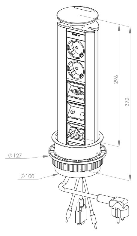
Einbaubohrung Ø 102 mm
