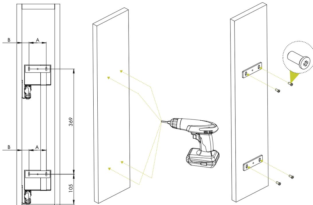
5. Зафиксируйте крепления (C) на корзине винтами.
