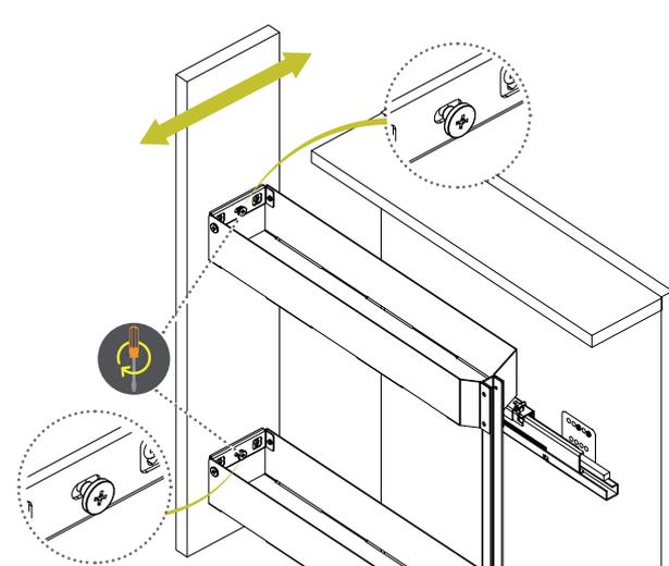
Ослабьте 4 винта 6,3x14 для регулировки фасада по вертикали.
