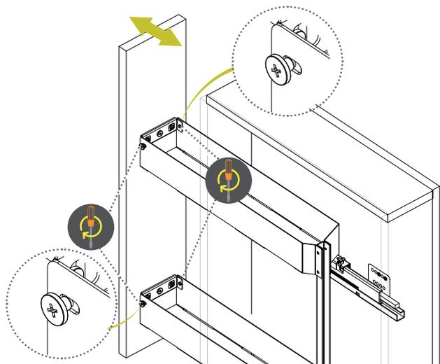
Ослабьте 2 винта M5x5 для регулировки фасада по горизонтали.
