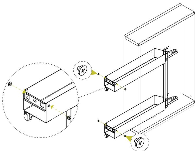
6. Закрепите фасад к корзине, соединив крепления (C и D).
