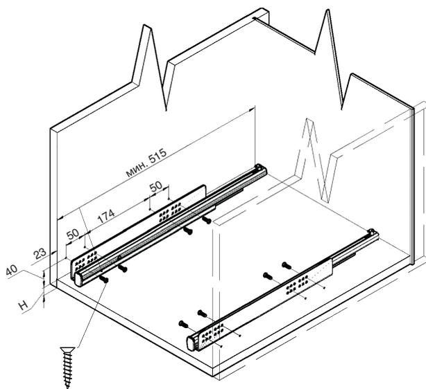
Минимальная глубина каркаса до задней стенки 515 мм.
